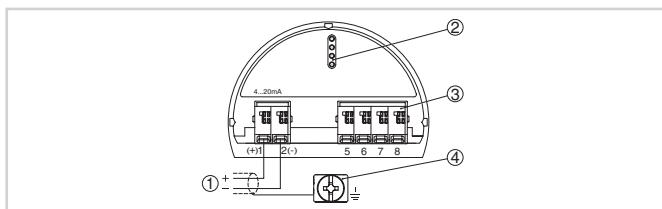
Отсек электроники и подключения (однокамерный корпус)
